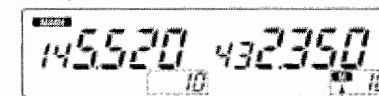
Il modo VFO è stato selezionato M evidenzia la selezione del modo Memory avvenuta.
